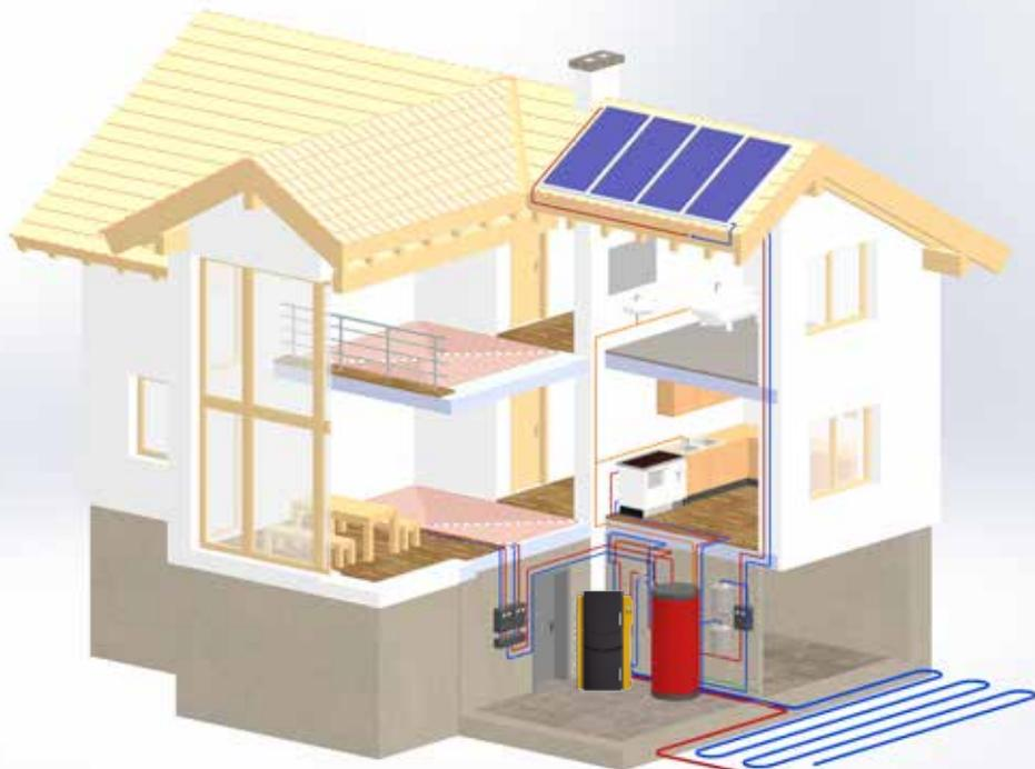
Abb.: Schnittbild Haus mit integriertem Heizungsherd
