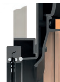
Tür abgesetzt zur Ofenhülle mit Anbaukante
