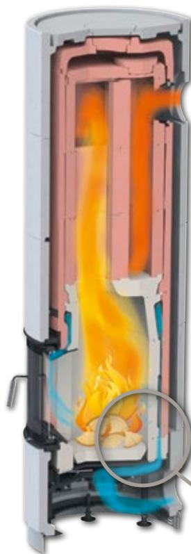
Verbrennungsluft- und Heizgasführung bei einem KSO 25r mit Verkleidung aus Wärmebeton und waagrecht Schornsteineintritt.
